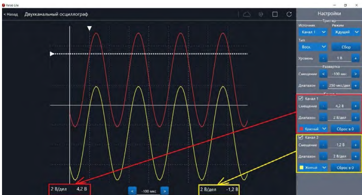
Рис. 39. Использование блока Каналы
