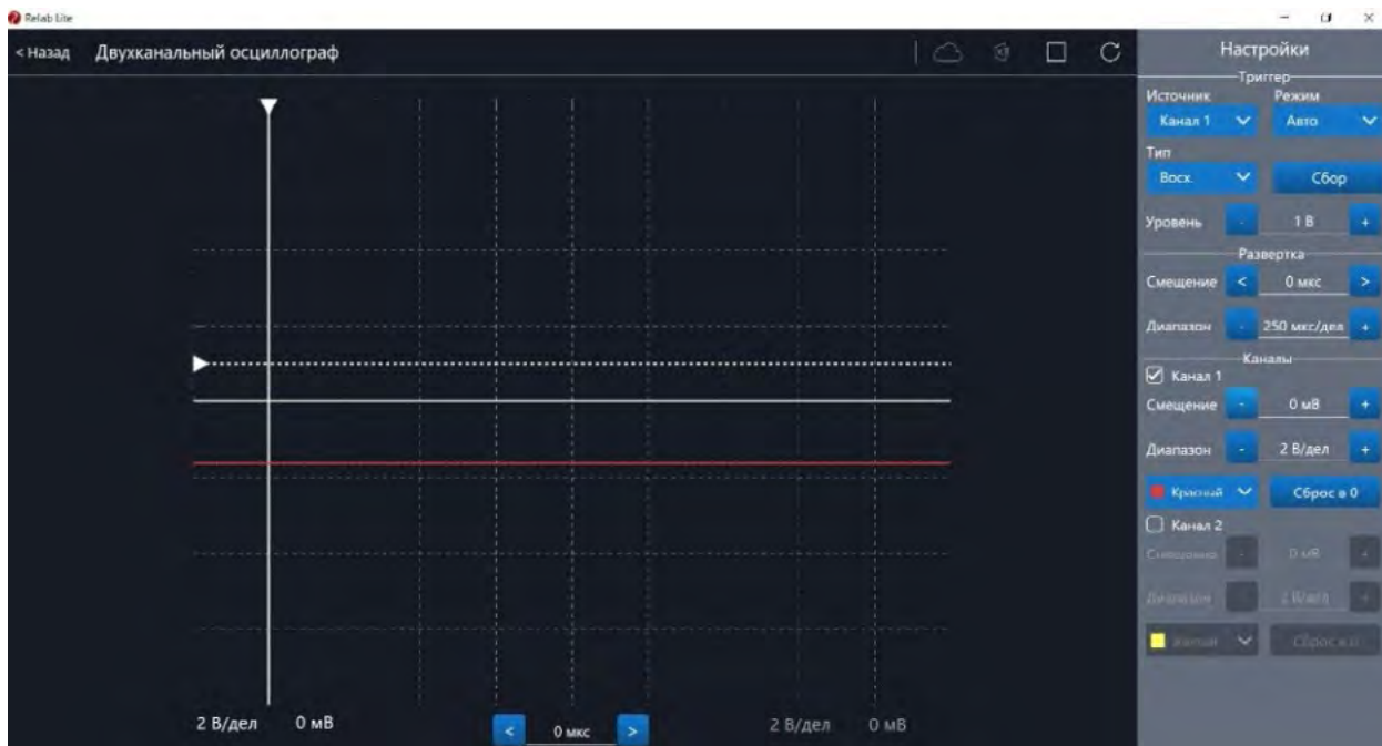
Рис. 40. Сигнал с ненулевым смещением
