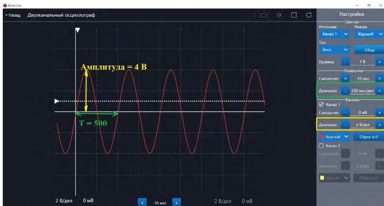
Рис. 42. Определение параметров осциллограммы
